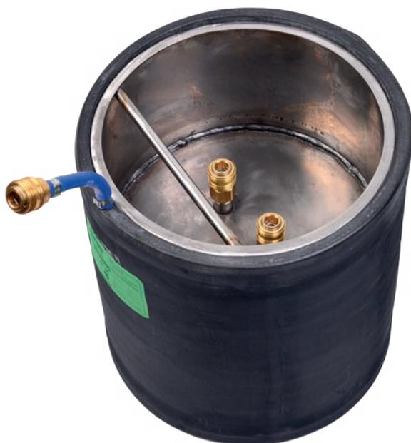
Diese Prüf-Dichtkissen eignen sich für Dichtheitsprüfungen von Standard-Schächten mit Wasser oder Luft nach DIN EN 1610. Prüfdruck ist 0,001 MPa (100 mm Wassersäule).
