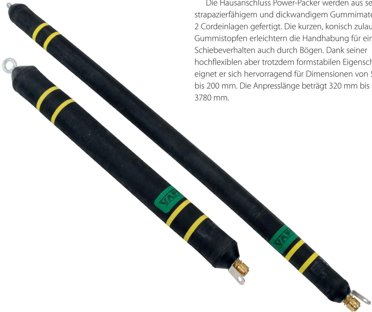
Die Hausanschluss Power-Packer werden aus sehr strapazierfähigem und dickwandigem Gummimaterial mit 2 Cordeinlagen gefertigt. Die kurzen, konisch zulaufenden Gummistopfen erleichtern die Handhabung für ein ideales Schiebeverhalten auch durch Bögen. Dank seiner hochflexiblen aber trotzdem formstabilen Eigenschaft, eignet er sich hervorragend für Dimensionen von 50 mm bis 200 mm. Die Anpresslänge beträgt 320 mm bis 3780 mm.
