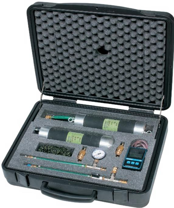
Dieses Prüfset ist für Dichtheitsprüfungen der Hausanschlüsse von 80–150 mm Nennweite mit Luft bestimmt. Es eignet sich sowohl für gerade Rohrabschnitte als auch für Bögen und Knierohre bis zu 90°. Das Set beinhaltet optional ein digitales Manometer sowie alle für Dichtheitsprüfungen nach DIN EN 1610 erforderlichen Armaturen und Zubehörteile. Optional gegen Aufpreis, Prüfblase für Luft und Wasser.
